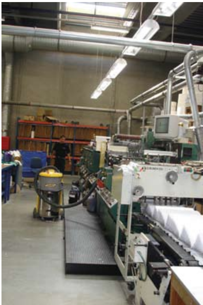
Denne Omet maskine kan trykke etiketter, der er op til 420 mm brede.
